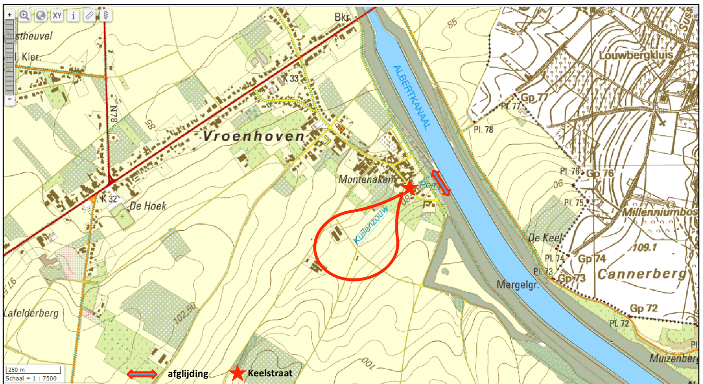
Fig. 2 Topografische kaart Vroenhoven en omgeving. In de doorgaans droogstaande Kuilenzouw en in de Keelstraat verzamelde zich op 27 mei 2016, met extreem grote neerslaghoeveelheid, zeer veel leemmodder. Via een erg smalle betonnen afvoer langs het westelijk talud van het Albertkanaal veroorzaakte dit een afglijding over een afstand van minstens 50 m en werd de ondergrond zichtbaar. Gevolg: ravage in het dorp en op het jaagpad... en een mooi geologisch kijkvenster
